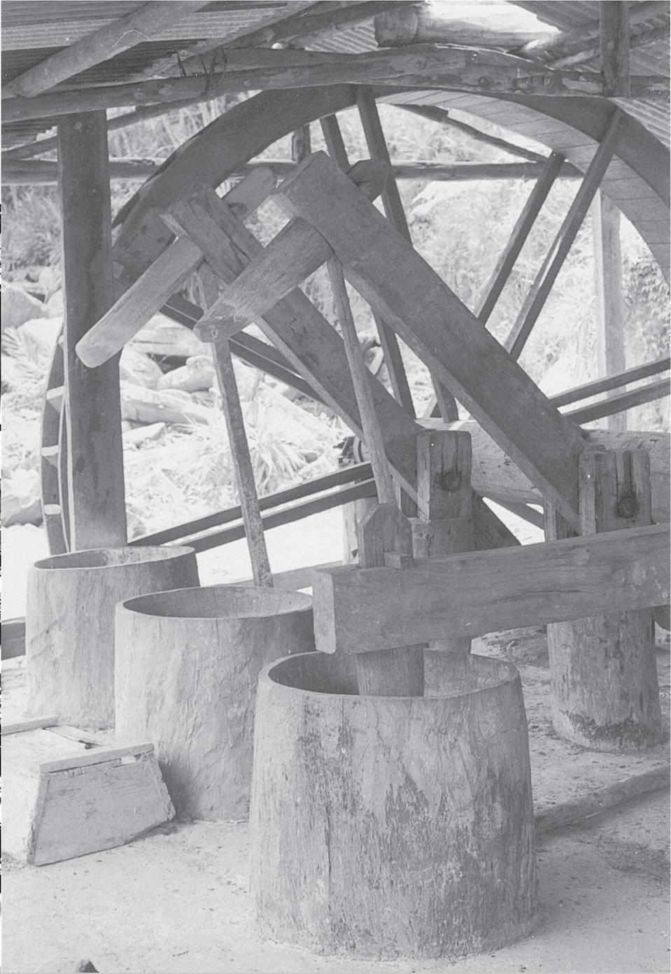
Monjolo de três martelos, funcionando com roda d'água.
